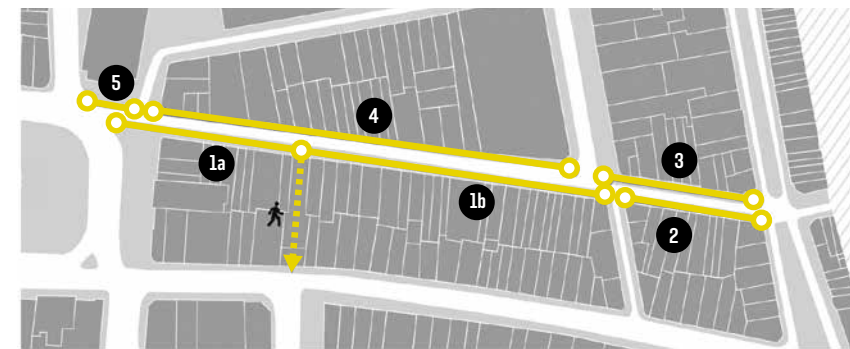
Figura 11.2: Segmento de calçada – unidade básica de coleta de dados e avaliação
